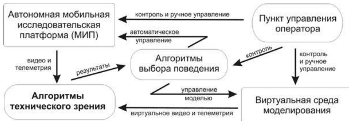
Рис. 1. Структура многоцелевого комплекса исследования КЗ
