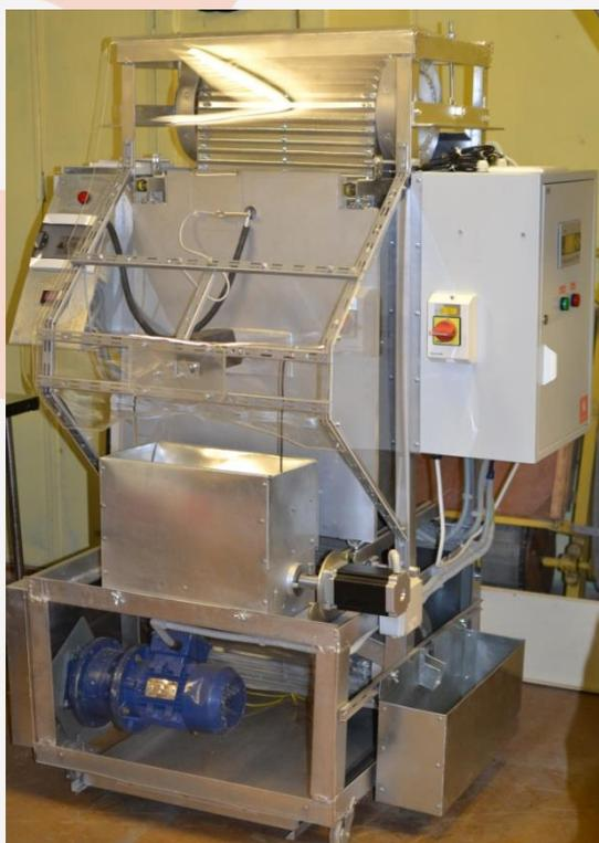
Рисунок 3 – Автоматизированный ленточный электростатический триер по сепарации семян овощных культур к.т.н. А.С. Угловского, д.т.н. Шмигеля В.В. С помощью ленточного электростатического триера можно получать семенной материал овощных культур с наибольшим количеством женских соцветий, повысить всхожесть семян, и соответственно, увеличить валовой сбор продукции до 30 %.
