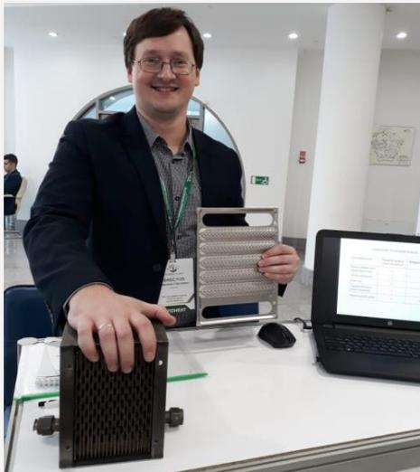
Модель пластинчатого теплообменника
