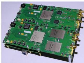
**Назначение:** Высокоскоростные системы передачи информации. Вид модуляции: DQPSK; Скорость передачи информации: 1 Гбит/с; Помехоустойчивое кодирование: код Рида-Соломона; Кодовая скорость: 0.7; Ширина полосы радиосигнала: 1.4 ГГц; Режим связи: полудуплекс с временным разделением; Рабочие частоты: X, Ku-диапазон.
