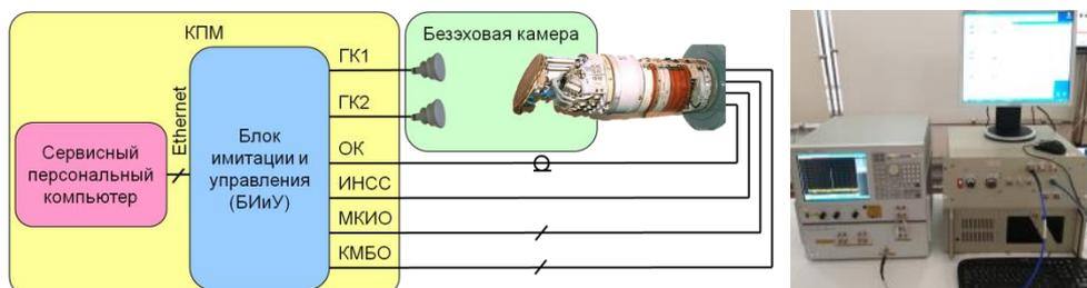
**Назначение:** для отладки и проверки функционирования полуактивной головки самонаведения (ПАГСН) зенитного ракетного оружия. Входящий в состав КПМ блок имитации и управления (БИиУ) обеспечивает формирование электромагнитных волн двух СВЧ сигналов X диапазона, имитирующих цели. Также БИиУ формирует опорный СВЧ сигнал ПАГСН и имитирует информационный обмен с ПАГСН с устройствами управления и телеметрии.
