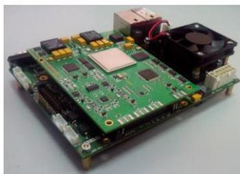
**Назначение:** Модуль предназначен для анализа и синтеза радиосигналов в реальном масштабе времени с возможностью программного управления параметрами обработки сигналов с использованием встроенной ЭВМ.
