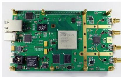
**Назначение:** Унифицированная плата цифровой обработки сигналов для построения радиотехнических систем различного назначения в диапазоне до 6 ГГц с полосой радиосигнала до 56 МГц.
