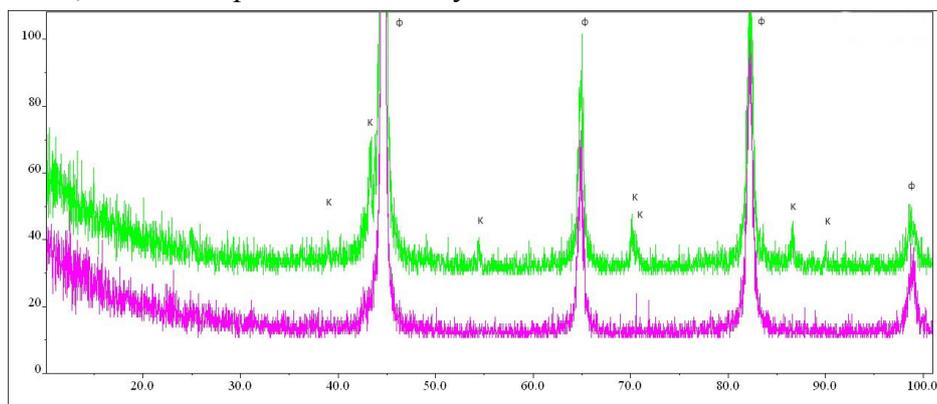
Фрагмент дифрактограмм образцов пружинных сталей. Зеленым цветом представлена дифрактограмма образца №1, фиолетовым - дифрактограмма образца №2. Буквами Ф отмечены рентгеновские рефлексы от феррита ( $\alpha$ -Fe), К - рентгеновские рефлексы от карбида железа Fe<sub>3</sub>C.
