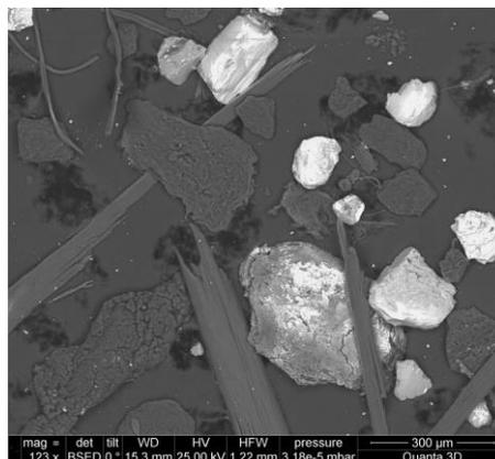
Рис. Элементный анализ и результаты элементного картирования образца Т/YN234. Вероятно содержание веществ, содержащих следующие комбинации элементов: Al-Si-O, Ca-O, Ca-O-C (?), Ca-Mg-O, Ca-Mg-C-O (?), C, C-O, C-O-S, C-S, Cr-Ni-Fe-O, Cu-Fe-Zn, Cu-Fe, Cu-Fe-Zn-S (?), Fe-S-O, Fe-S-O-Zn, Fe-S-Zn, SiO, S, S-Ti, S-Ti-O (?)
