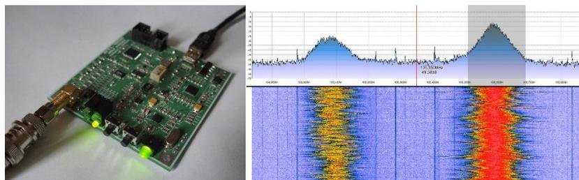
**Назначение:** предназначен для приема радиосигналов в диапазоне от 30 кГц до 1700 МГц и полосой обзора до 3 МГц с использованием последующей компьютерной обработки.
