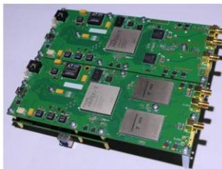
**Назначение:** Высокоскоростные системы передачи информации. Вид модуляции: DQPSK; Скорость передачи информации: 1 Гбит/с; Помехоустойчивое кодирование: код Рида-Соломона; Кодовая скорость: 0.7; Ширина полосы радиосигнала: 1.4 ГГц; Режим связи: полудуплекс с временным разделением; Рабочие частоты: X, Ku-диапазон.
